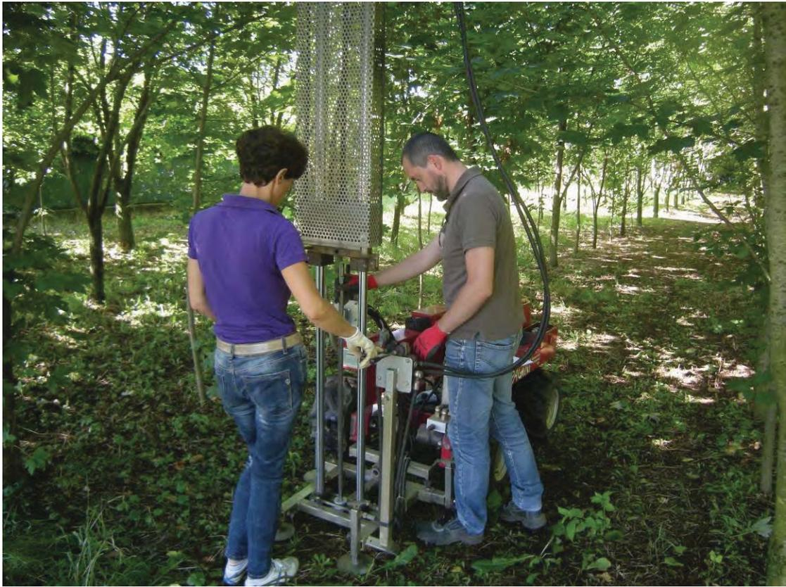
Foto 1: Esecuzione della prova penetrometrica n°1
