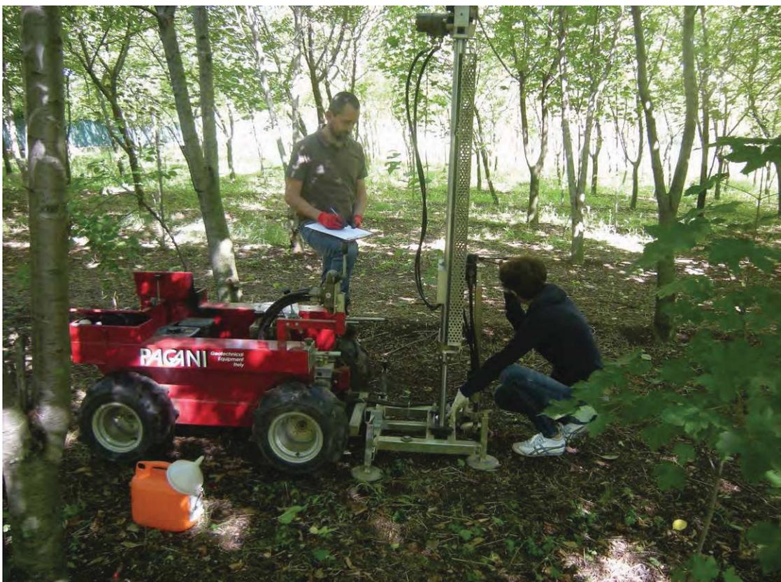
Foto 2: Esecuzione della prova penetrometrica n°2
