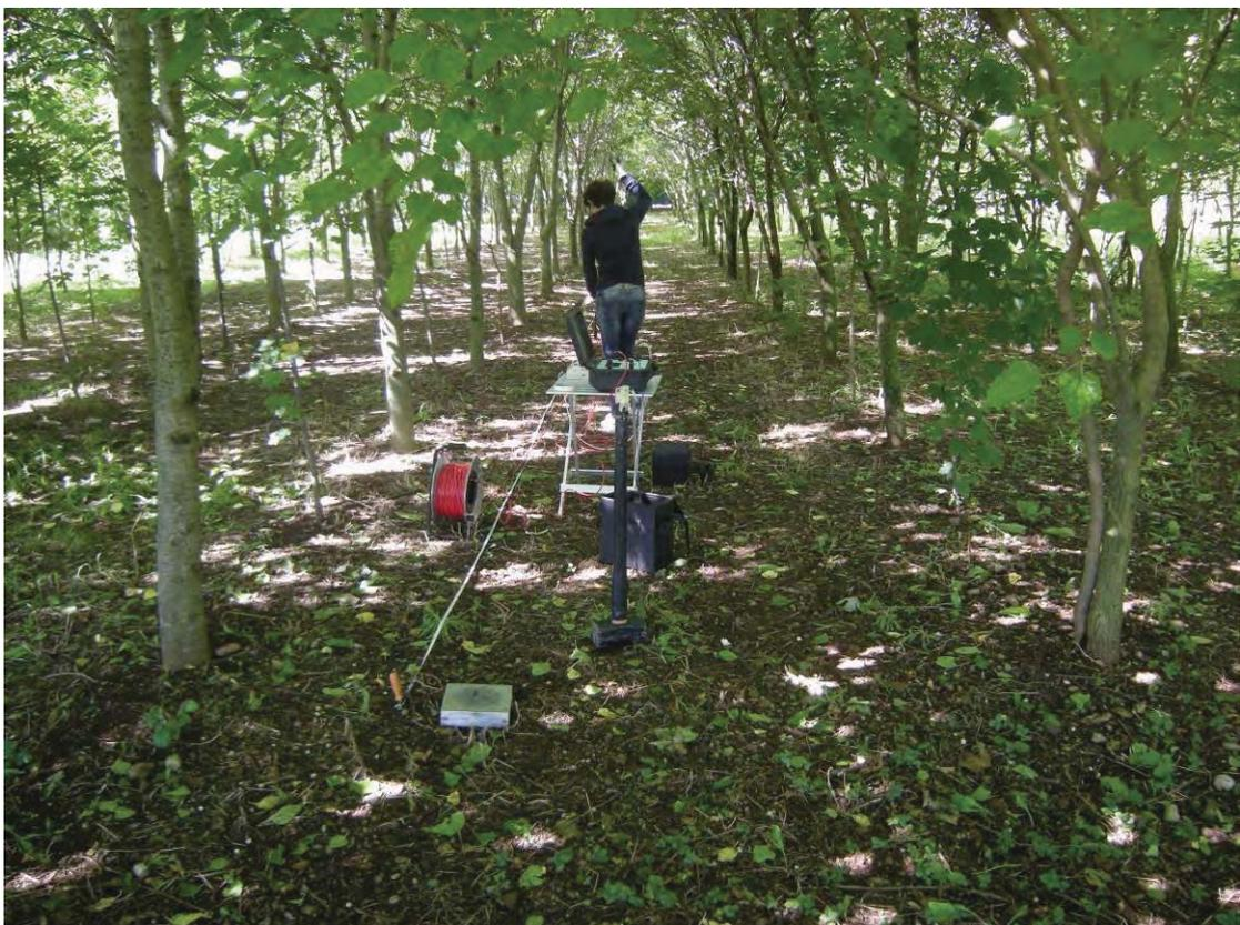
Foto 4: Esecuzione dello stendimento sismico
