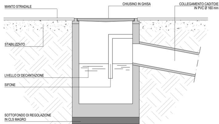
SEZIONE POZZETTO A CADITOIA IN CLS
