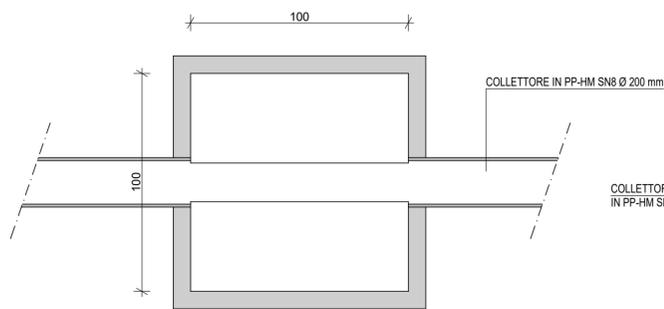
PIANTA POZZETTO D'ISPEZIONE
