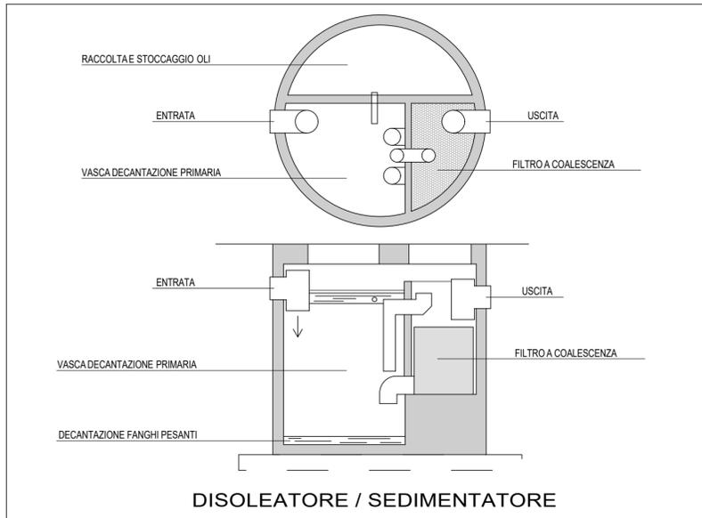
DISOLEATORE / SEDIMENTATORE
