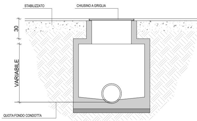
SEZIONE POZZETTO D'ISPEZIONE
