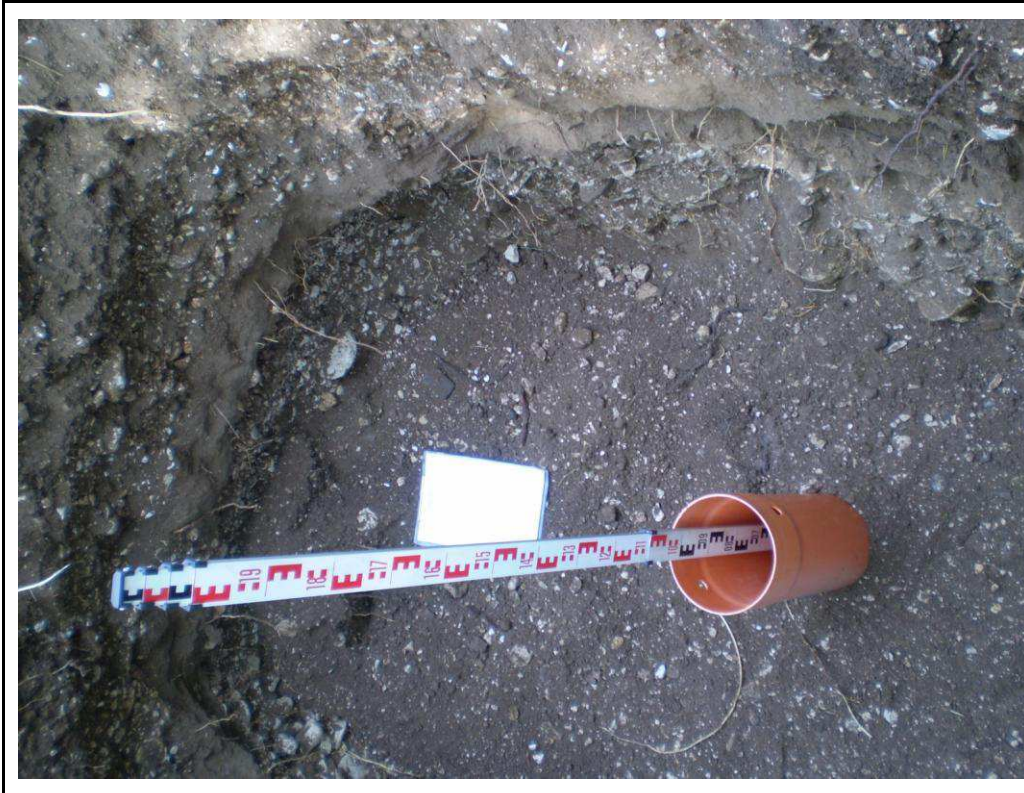
Foto 2: Test di permeabilità K1 (profondità 2,80 m)
