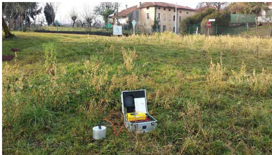
Foto 4: Esecuzione dell'Indagine Sismica Passiva con tecnica "HVSR"
