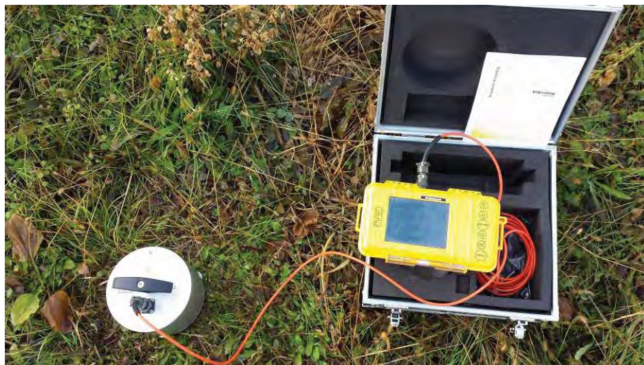
Foto 5: Sensore sismico 3D frequenza 2Hz e Sismografo digitale Vibralog a 24 bit (M.A.E.)
