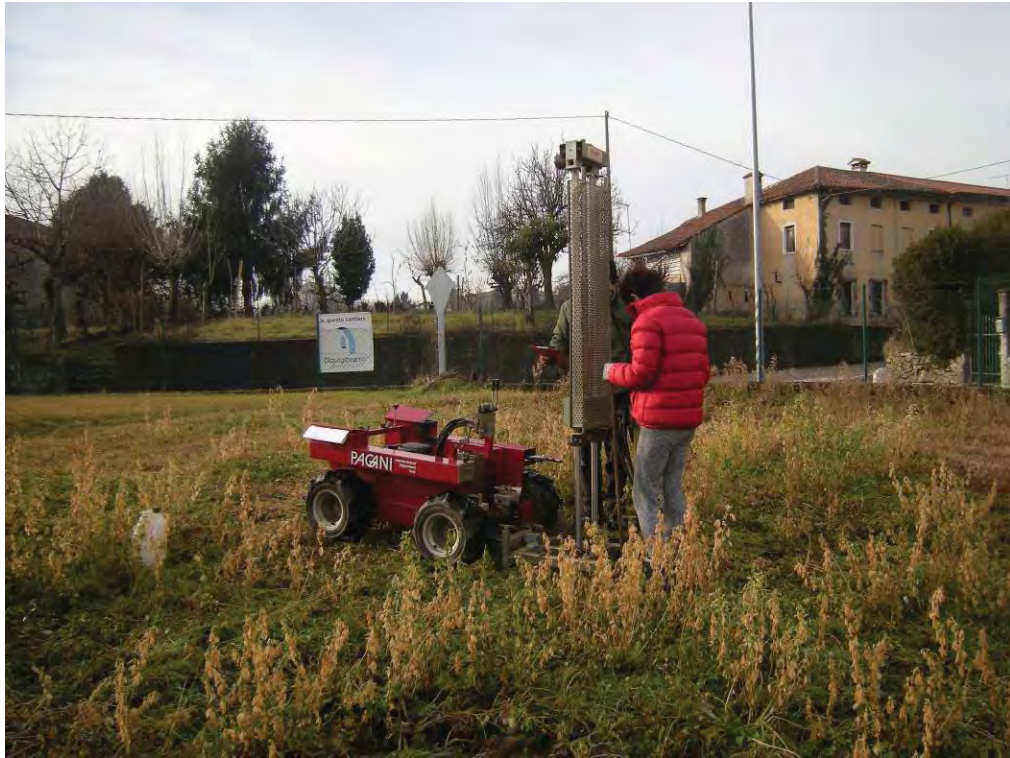
Foto 3: Esecuzione della prova penetrometrica n°3
