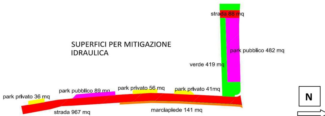
**fig. 2** – Planimetria delle superfici dell'area lottizzata ed individuazione delle aree a standard. Nella parte di calcolo della presente relazione viene considerata anche la superficie della strada di v. Ca' Nova con direzione circa N-S, Si rimanda al progetto dell'arch. A. Cavaleri.
